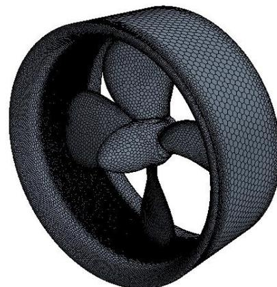
*Fig. 3. Propeller mesh*
