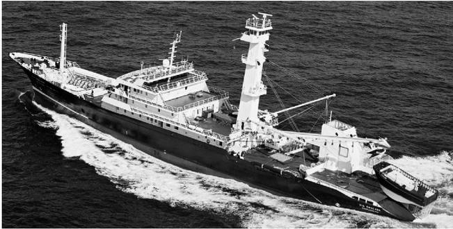
Figure 1. Diesel-electric tuna seiner Via Gwalarn
